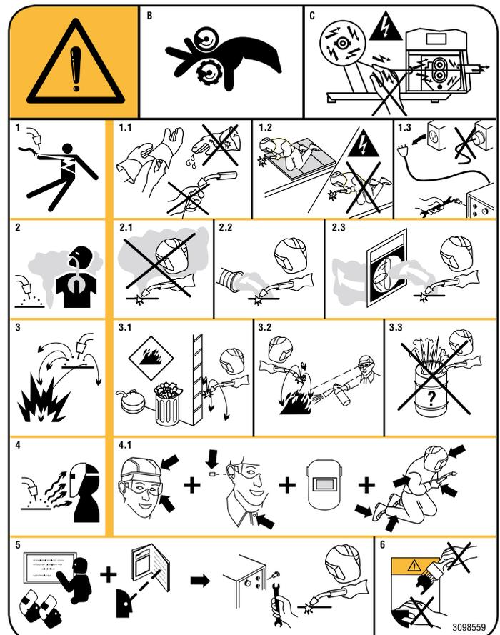
1. Os choques elétricos provocados pelo eletrodo de soldagem ou pelo cabo podem ser mortais. Proteja-se devidamente contra o perigo de choques elétricos.
