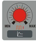
Em processo de Eletrodo Revestido (MMA) ajusta-se o tempo de Hot Start em centésimos de segundo; na prática ajusta-se uma sobrecarga de corrente que tem função de melhorar a partida do arco elétrico. Em processo de soldagem TIG Contínuo não possui função.
