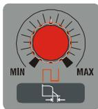
Em processo de soldagem por Eletrodo Revestido (MMA) com esta chave pode se ajustar o porcentual de corrente de "Arc Force"
