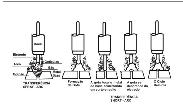
FIGURA 7 - A transferência Spray-Arc e Short-Arc.
