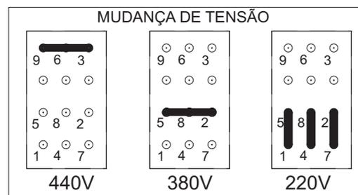
FIGURA 5 - Esquema de troca de tensão de alimentação
