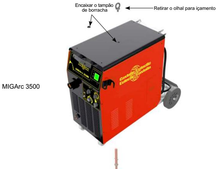
Todos os modelos MIGArc 3500 são montadas na fábrica com um olhal para içamento para facilitar o embarque e desembarque. Recomenda-se retirá-lo (rotacionar no sentido antihorário) após a instalação da máquina. Para preservar a classe de proteção e prevenir a infiltração de água e outros objetos no interior da máquina, tampe esta furação com o tampão de borracha que acompanha o equipamento (enviado junto com o manual de instruções).
