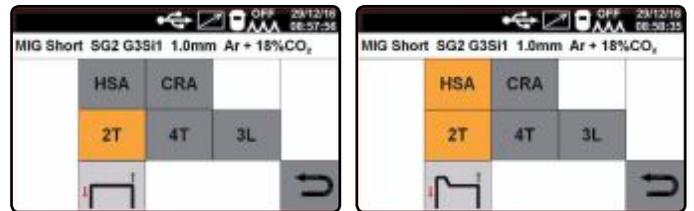
Depois de ativado o parâmetro **HSA**, o operador poderá regular a Corrente inicial de 10 a 200% da corrente de soldagem. Poderá regular o Tempo de corrente de 0,1 a 10 segundos. Também poderá regular o Tempo de união entre a corrente inicial e a corrente de soldagem de 0,1 a 10 segundos.
