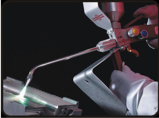
**Aplicações:** Revestimentos em peças de vidrarias como fôrmas, blocos, coroas, contramoldes, arruelas, soldar insertos de carboneto de tungstênio em estabilizadores, revestimento de peças em geral
