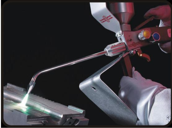
**Aplicações:** Revestimentos em peças de vidrarias como fôrmas, blocos, coroas, contramoldes, arruelas, etc. Recuperação de peças em geral.
