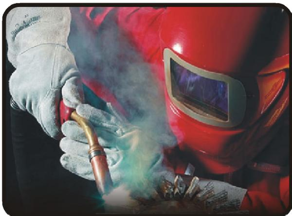
**Aplicações:** Para revestimento em ferramentas de trabalho a quente como matrizes, insertos, rebarbadores em forjarias, mol-des de injeção de ligas leves, facas para corte a quente, etc. Para revestimentos em partes e peças sujeitas a altas tensões de compressão com atrito metal-metal acompanhado de choques térmicos, como rolos de lingotamento contínuo, roletes de moendas.
