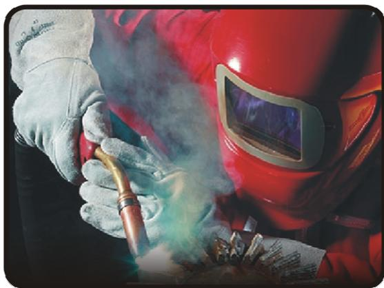
**Aplicações:** Soldagem da camada de base no revestimento de Frisos de Moendas, recuperação de quebra de frisos, recuperação de peças e partes em ferro fundido.
