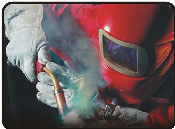
**Aplicações:** Soldagem da camada de base no revestimento de frisos de moendas; recuperação de quebra de frisos.
