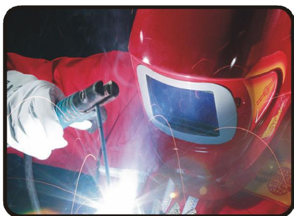
**Descrição:** Eletrodo do tipo Cr/Ni usado para soldagem de aços inoxidáveis em ambiente de alta corrosão quando ocorre corrosão por "pitting" ou "crevice". Superior resistência a corrosão. Atende as Normas AWS A5.4 E 317 L-16 / AWS A5.4 E 317 L-17.
