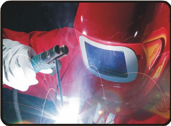
**Descrição:** Arame tubular contendo 2,5% de Ni para soldagem de aços de baixa e média resistência onde a alta tenacidade é necessária. Permite produtividade extra utilizando em modo Spray, comparando aos arames tradicionais básicos em modo curto circuito para soldagem vertical e sobre cabeça.
