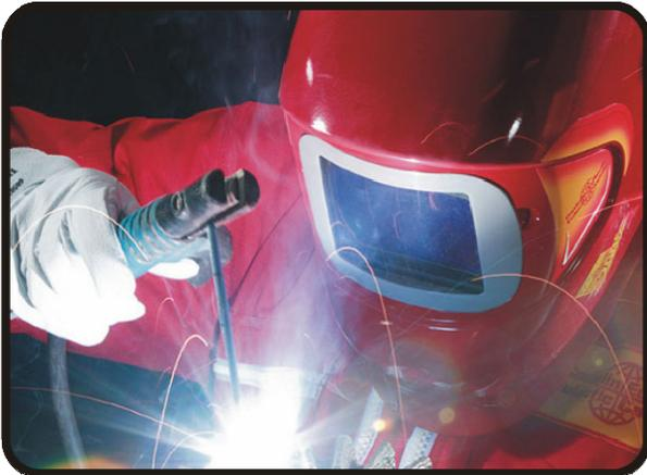
**Descrição:** Eletrodo básico para soldagem de aços ligados ao molibdênio, resistentes ao calor.
