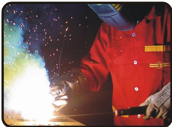
**Aplicações:** Em manutenção e reparo por soldagem há sempre necessidade de chanfrar, cortar, goivar ou furar. Constitui parte importante na preparação da peça. A remoção de depósitos corroídos, gastos, fatigados, com poros ou trincas permite a perfeita ligação da solda ao metal base. O eletrodo Eutectic Castolin de remoção de metal é de ação rápida, fácil manejo e baixa aplicação de calor no metal base.
