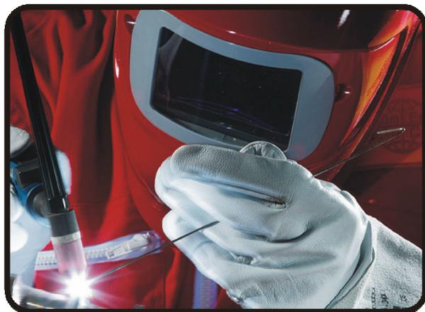
**Aplicações:** Para soldagem de estampos de corte, ferramentas de estampagem profunda e rebarbação, facas para corte de chapas finas, placas de revestimentos de molde para materiais cerâmicos, utilizando o procedimento desenvolvido pelo Instituto Eutectic Castolin sem pré-aquecimento como aços VC e VND.
