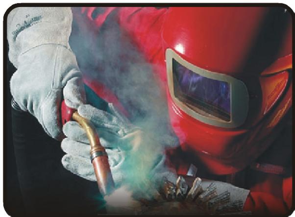
**Aplicações:** Pelas características do metal depositado, as aplicações principais são relacionadas a placagens e revestimentos de peças que sofrem o desgaste metal-metal ou corrosão salina, como em bombas, eixos, hélices em Bz-Al, revestimento e placagens de peças em aços C e/ou ferro fundido.
