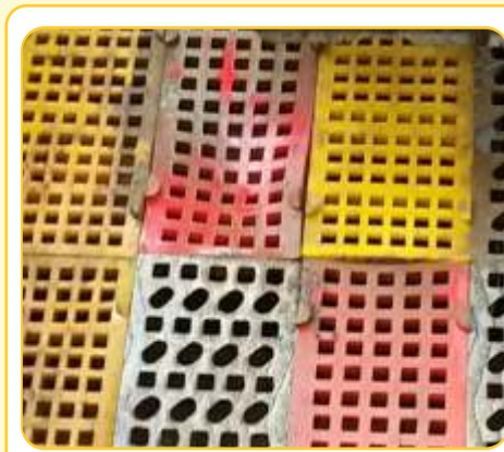
Comparação entre tela CDP 4666 + PU x tela em PU – vejam o desgaste nas telas em PU e a deformação devido ao choque do material abrasivo (minério de ferro)
