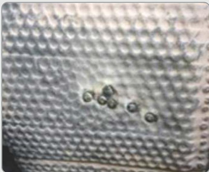
Como exemplo de aplicação na indústria do Cimento, o revestimento com NanoTecnologia está sendo utilizado em áreas críticas de rolos de moagem cerâmicos, proporcionando um prolongamento da vida útil dos rolos pelo reparo localizado com pontos de soldagem.
