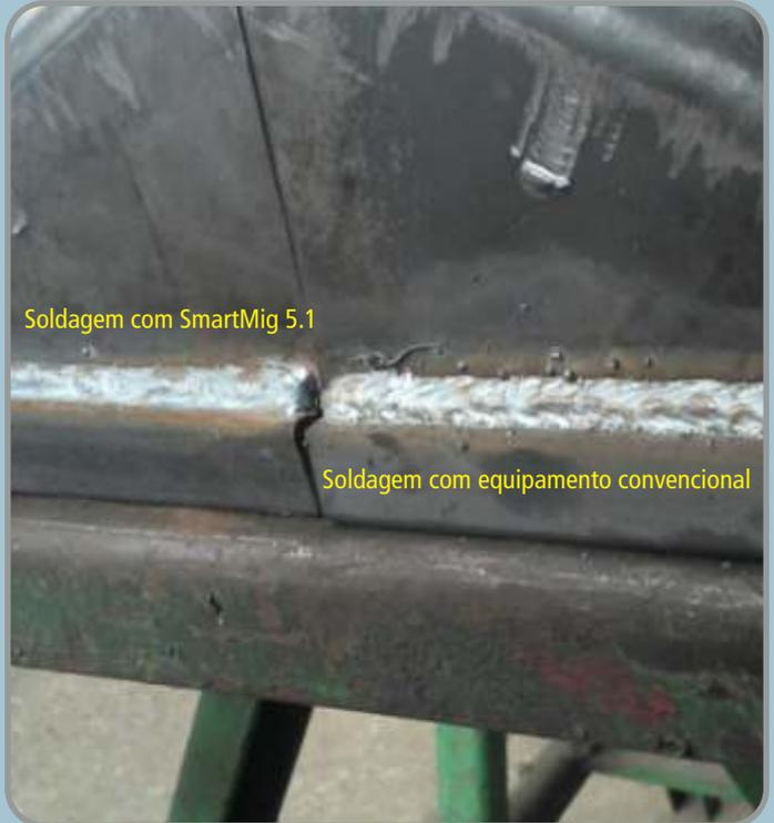
Porém para este modo de transferência, em máquinas convencionais é necessário a utilização de parâmetros com altas correntes e tensões, não sendo possível utilizar em todas as aplicações.
