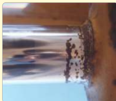
Cromo Duro 682 horas de vida útil
