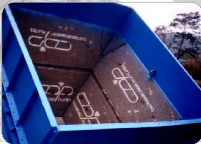
uso do **XHD 6395 N**, no processo de arame tubular com o uso do **DO\*395 N** ou ainda utilizando a tecnologia de placas antidesgaste com o uso do **CDP 4695 N**.
