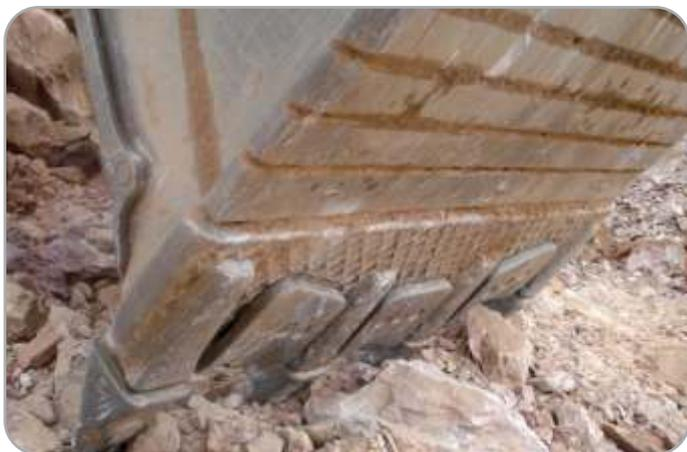
Após 12 meses de operação com Projeto Rental, onde aplicamos uma solução de materiais antidesgaste e estrutural nas caçambas, diferentemente cada problema, pois entendemos que o desgaste abrasivo não é o único que estava impactando a frota de caçambas, assim conseguimos um grande sucesso registrando uma vida útil média das caçambas de 4000 horas, tendo caçambas com 4800 horas em operação.
