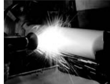
O sistema EuTronic Arc Spray 4 é um equipamento de Aspersão Térmica de alta produtividade. O processo Arc Spray consiste na alimentação de 2 arames sólidos ou tubulares, os quais são energizados e na tocha formam um arco elétrico, fundindo os arames a uma temperatura de 5000 °C. A liga fundida é projetada na peça que é mantida a uma temperatura inferior a 200 °C evitando distorções e alterações metalúrgicas.
