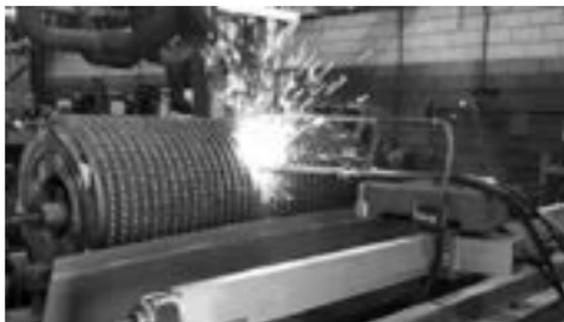
Equipamento para aplicação de chapisco em camisas de moendas em usinas de açúcar & etanol.
