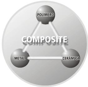
É a união de 2 ou mais materiais que pertencem aos 3 grupos bases: metais, cerâmicos e polímeros. O material composite faz com a sua estrutura tridimensional reticulada, uma forte ligação com o material de base através de uma reação físico-química de superfície.
