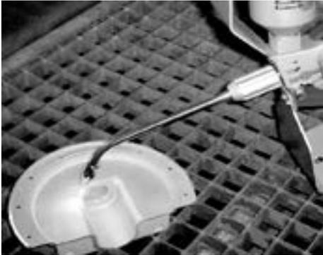
O SuperJet Eutalloy é um sistema de deposição de pós metálicos a base de Níquel e adição de Boro e Silício com ou sem Carbonetos de Tungstênio, utilizado para recuperação e revestimento de peças, com espessura de 0,1 a 10,0 mm e durezas de 18 a 60 HRC.
