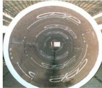
Na fabricação de tubos com placas convencionais, não é possível alinhar as trincas e o overlap a 45° do fluxo abrasivo, gerando desgaste severo prematuro por partículas finas. Com CDP SinusWave, o fluxo abrasivo não terá um caminho preferencial, aumentando a vida útil em mais de 50%.
