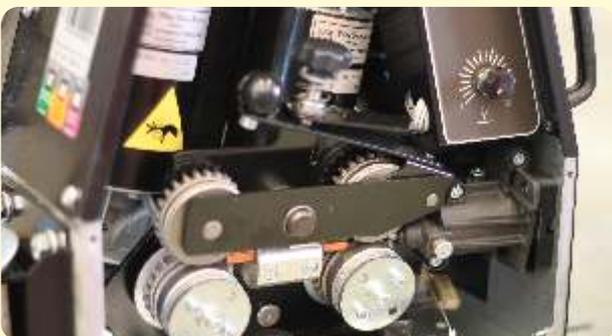
Novo cabeçote com 2 motores e novo sistema de conduíte especialmente desenvolvido para transporte do arame tubular do cabeçote ao bico de contato.
