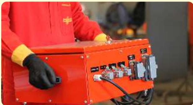
RoboTec Smart possui proteção IP 65 (Teste com jato d'água, totalmente protegido contra a entrada de poeira) - motores, tomadas, IHM e CPU.
