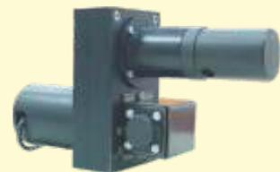
Encoder – Interface da Moenda x RoboTec Max – sensor responsável pela leitura do movimento do conjunto.
