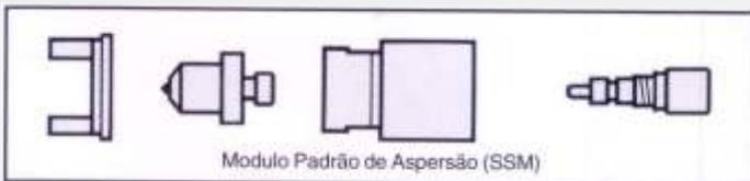
Devido a grande variedade de ligas micropulverizadas desenvolvidas pela Eutectic Castolin, ligas metálicas a quente, ligas metálicas a frio, ligas cerâmicas, ligas metálicas de baixo ponto de fusão e polímeros, foram desenvolvidos quatro Módulos Padrão de Aspersão (SSMs) para o CDS 8000. Cada SSM é otimizado para se obter revestimentos da mais alta qualidade.
