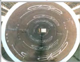
Para reduzir o desgaste nas trincas das placas revestidas em tubulações, utilizamos a tecnologia SinusWave. Com isto conseguimos aumentar em até 30% a vida útil comparada com o uso de placas com cordões retos.
