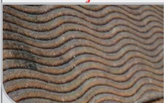
Sem o caminho preferencial de desgaste entre os cordões e as trincas características dos revestimentos duros, a vida útil do revestimento dos misturadores pode ser aumentada em até 30%.
