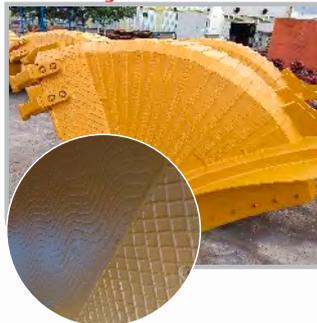
Partículas abrasivas geram desgaste severo que se iniciam nas trincas e overlap dos cordões nas chapas convencionais. Com CDP® 4668 SinusWave isso não ocorre pois não existe caminho preferencial para as partículas abrasivas, evitando desgaste prematuro no bojo e laterais das caçambas, aumentando a vida útil em mais de 20% comparado com placas convencionais.
