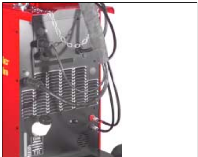
Abb.7f Verbindungsschlauchpaket an der Stromquelle
