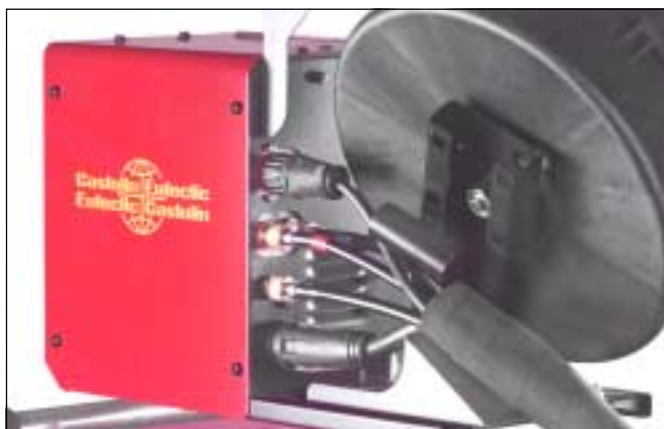
Ilustr. Tg Paquete de mangueras en el avance de alambre
