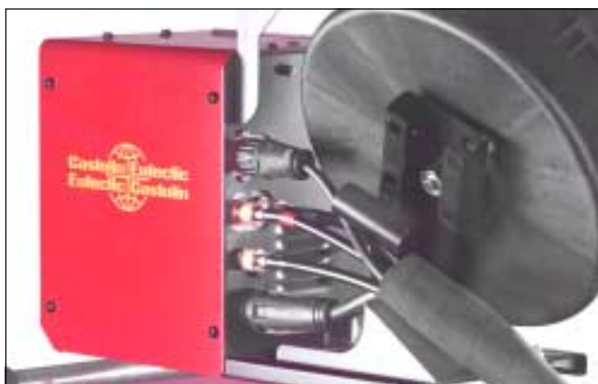
Ill. 7g Pacco tubo collegamento nell'avanzamento filo
