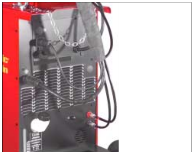
Fig. 7f Faisceau de câbles de connexion sur la source de courant
