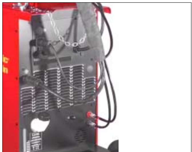
Ilustr. 7f Paquete de mangueras de conexión en la fuente de corriente
