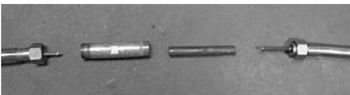
Pegue o acoplamento de extensão do acionamento flexível (peça no. 263148), engraxe-o levemente e insira-o no conector do acionamento flexível (peça no.263149). Use este acoplamento para conectar dois acionamentos flexíveis juntos. Recoloque os acionamentos flexíveis no sistema DUA de alimentação de arame
