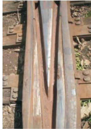
Jacaré desgastado com núcleo em aço manganês
