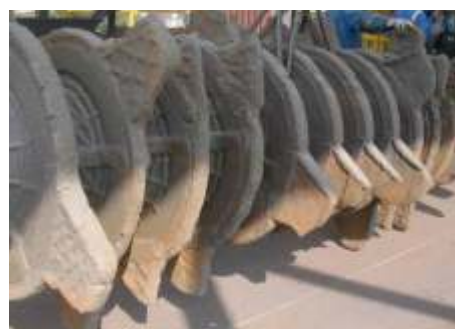
Solução convencional após 10 meses de operação, rotor completamente desgastado
