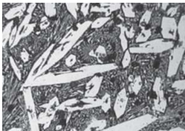
Aumento 200 X ataque nital 2 % – Metalografia do EC 4601 Hard com CrC e B_4C
