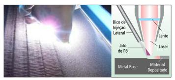
Uso da tecnologia Laser para revestimento de placas e peças
