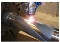
**Tipos de Carbonetos** – Com a tecnologia Laser Clad podemos aplicar diferentes tipos de materiais e selecionamos o material de acordo com a análise de desgaste.
