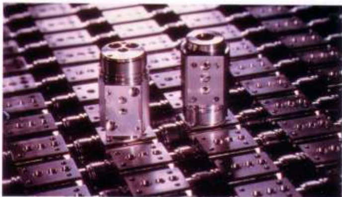
Componentes CDS 8000 usinados com CNC para máxima precisão.
