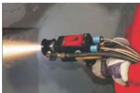
O ArcJet é ajustado à tocha para injetar ar na frente do bocal. ArcJet comprime a configuração da aspersão reduzindo assim o tamanho do jato de aspersão e permitindo aplicação em áreas mais confinadas tais como ranhuras profundas. Dessa forma, podem ser obtidas melhorias significativas na eficiência do depósito especialmente em componentes de diâmetro reduzido.
