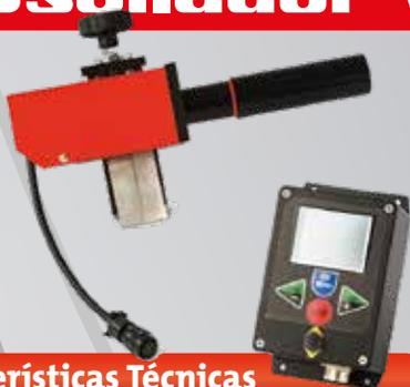
A unidade de oscilação W8000 pode ser usada para mecanizar seu processo MIG/MAG quando for necessário oscilar, preencher lacunas, preencher ou tampar. Programas armazenáveis para velocidade de oscilação, largura, tempo de espera, tempo de entrada e pré-aquecimento. A Unidade de Oscilação W8000 tem uma largura máxima de oscilação de 60 mm.
