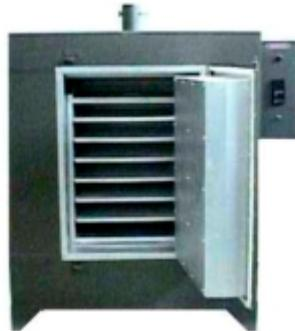
**Estufa de Manutenção de Secagem:** Devem ter termostato e termômetro. A estufa deve manter a temperatura até 200°C. Estas estufas devem permitir a circulação do ar.
